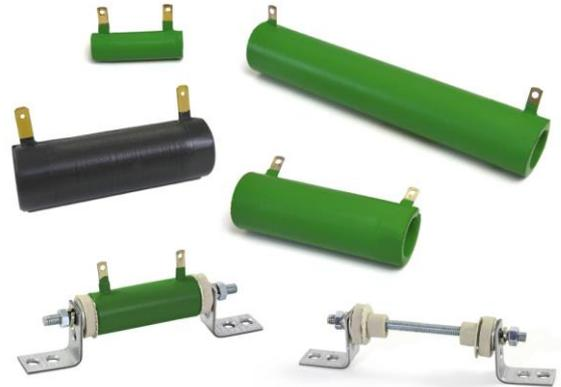
Drahtgewickelter Festwiderstand der allgemeinen Anwendung, isoliert, für Überkopfmontage. Widerstände sind für den Einsatz in Wechsel- und Gleichstromkreisen konzipiert und dienen der Strombegrenzung und Spannungsverteilung.
